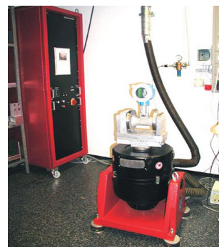
Obr. 2 Vírový prietokomer Prowirl v laboratóriu pri testovaní odolnosti proti vibráciám
