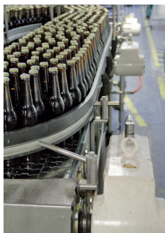
Výstupné dopravníky od plničky fliaš
